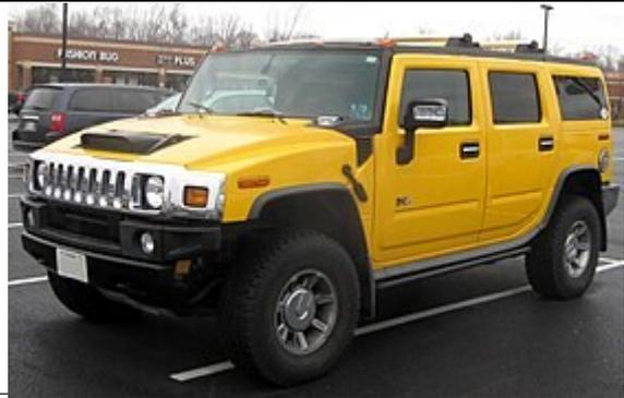
Un Hummer h2 de 2900 kg, équipé du moteur v8 de 6.0 litres parcourt le 0 à 100 km/h en 12s, sur un circuit adapté (ligne droite), vitesse maxi 180 km/h.
